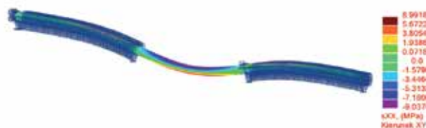
Fot. 12. Wykresy naprężeń i ugięć dla stanu związanego ze skręcaniem gazociągu.
