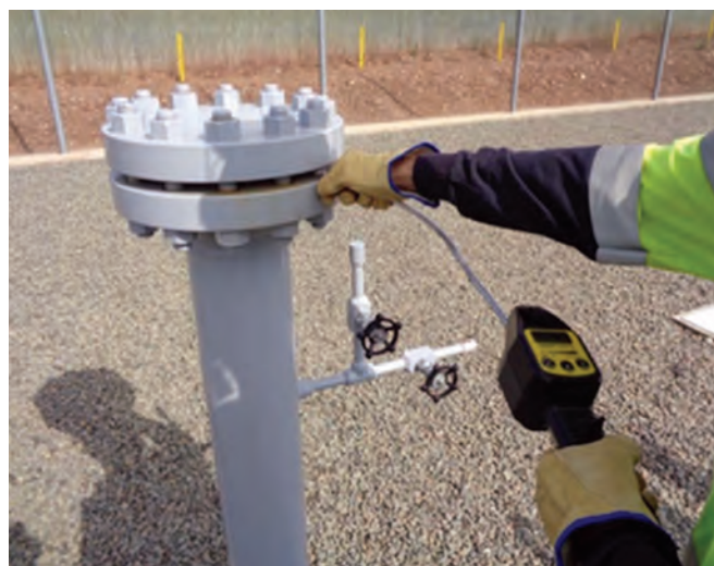
Rysunek 5. Przykład inspekcji LDAR z wykorzystaniem Metody 21 [6]
