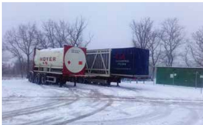
Zdjęcie 4. Mobilna stacja regazyfikacji LNG.
