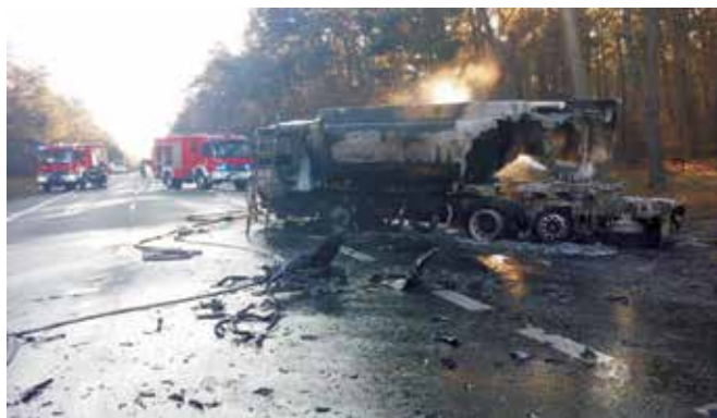
Rysunek 2. Zniszczona cysterna po pożarze zainicjowanym rozlanym paliwem
