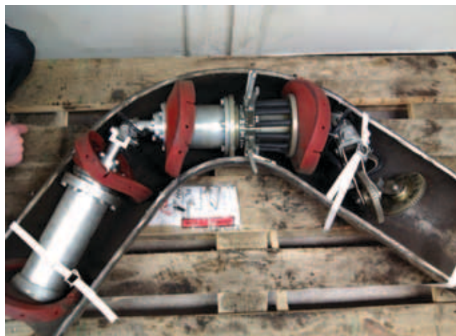
Rys. 1. Uwieszenie tłoka w ostrym łuku.
