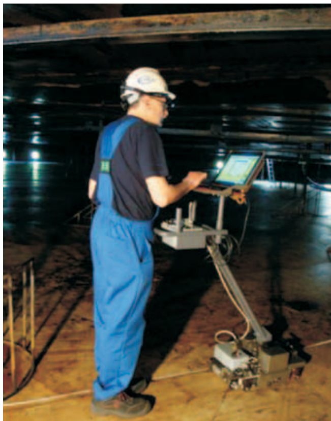
Rys. 2. Skaner magnetyczny KORMAG MSC-07 podczas inspekcji zbiornika*.
