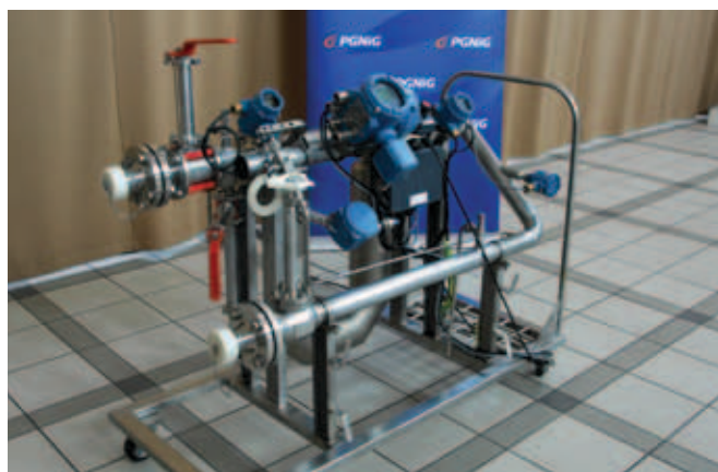
Rys. 2. Przewoźne stanowisko legalizacyjne i pomiarowe SMOK.
