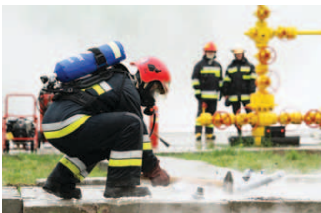
Próba rozbicia zaworu poddanego działaniu ciekłego LNG, nieprzewidzianego do pracy w warunkach kriogenicznych.
