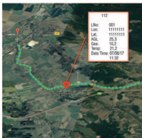
Rys. 4. Dane lokalizacji wycieków 2 .
