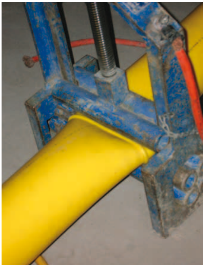
Fot. 3. Rura z poliamidu PA12 (VESTAMID® NRC) zaciśnięta w ścisisku hydraulicznym.
