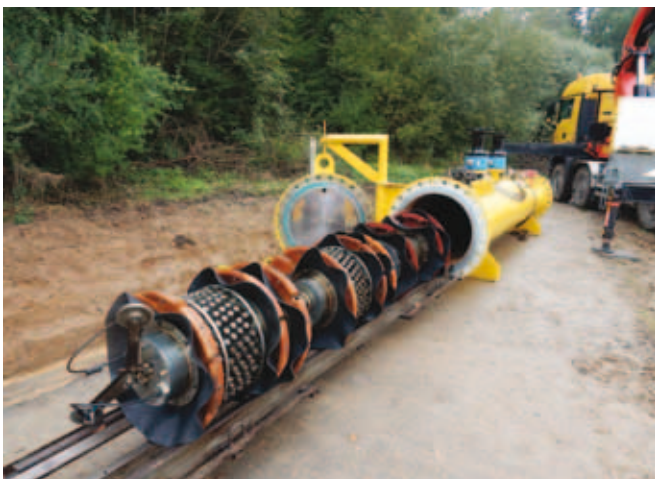
Rysunek 1. Tłok UT w trakcie montażu w służbie nadawczej
