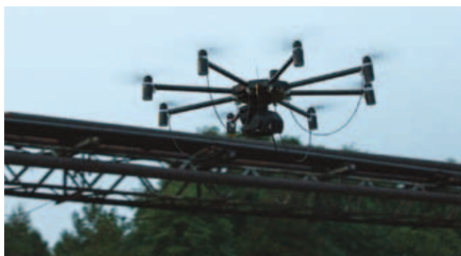
Dron z kamerą termowizyjną nad badaną instalacją.
