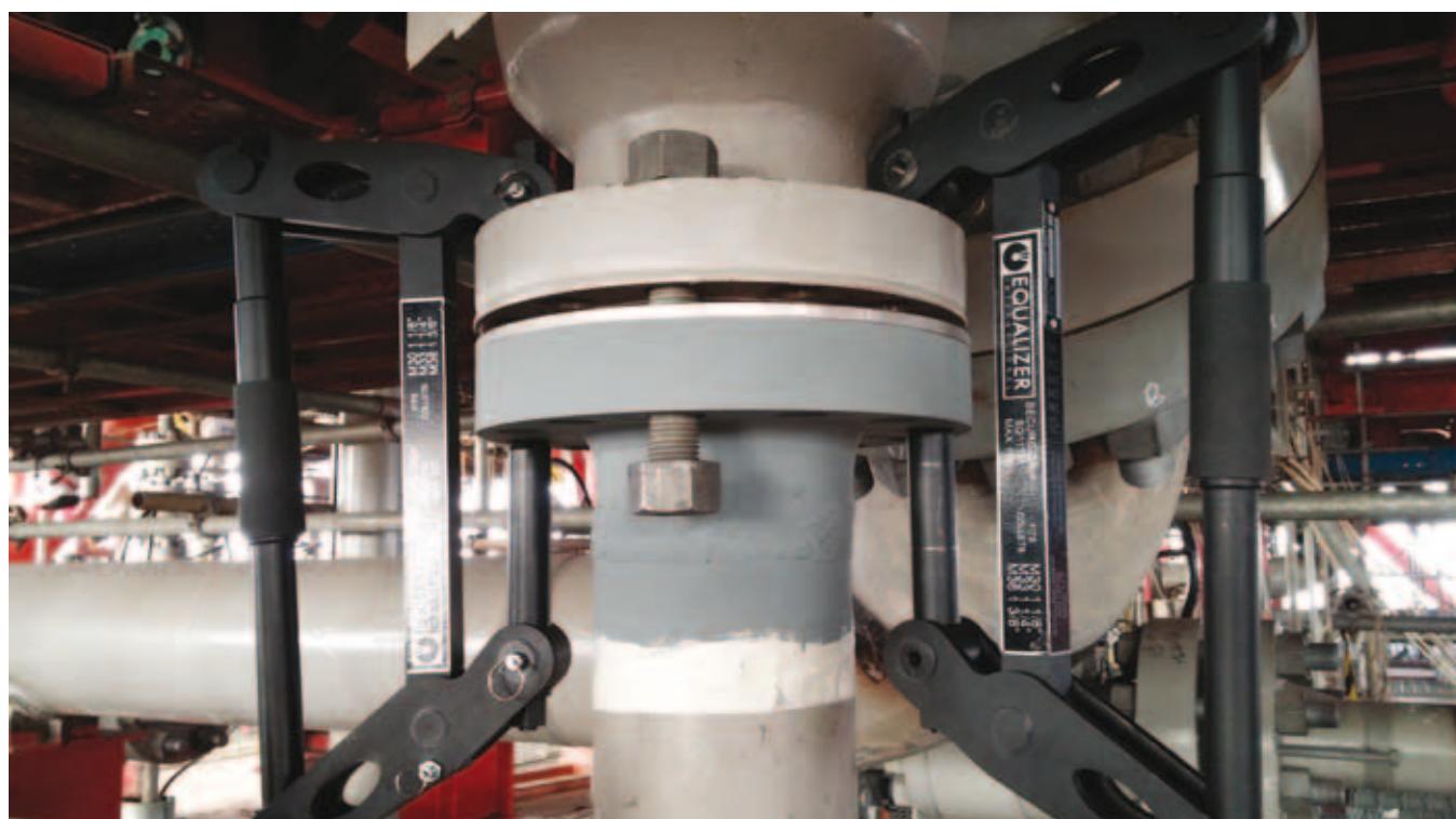
Narzędzie do rozpięcia połączeń kołnierzowych SG11TM.
