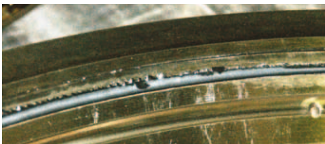
Ekstruzja szczelinowa uszczelki głównej.
