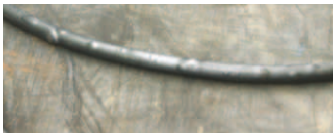
Pęcherze dekompresyjne w uszczelce „dynamicznej”.
