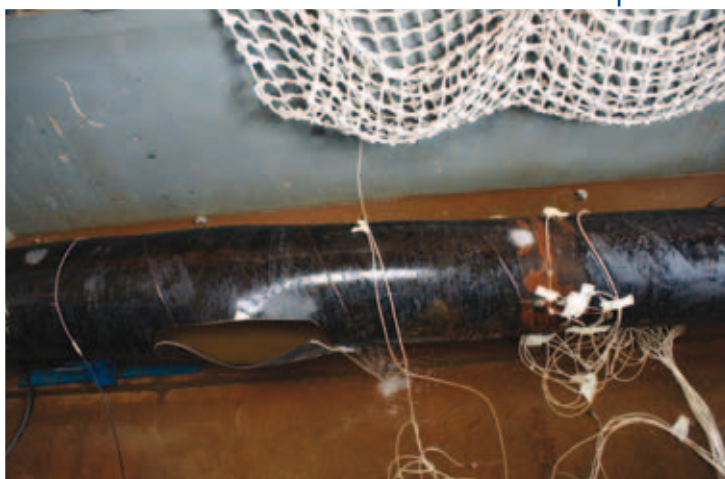
Badania w firmie CEPS a.s.: próbka TV11 – rozerwanie rury za pomocą ciśnienia wewnętrznego.
