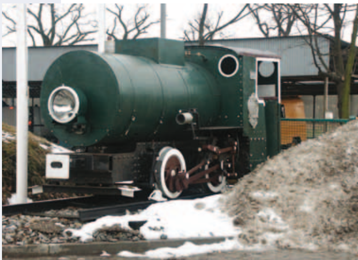
Maszynę nr 6 ustawiono na pamiątkę w macierzystym zakładzie; w miejscu zaworu zasilającego zamontowany reflektor.
