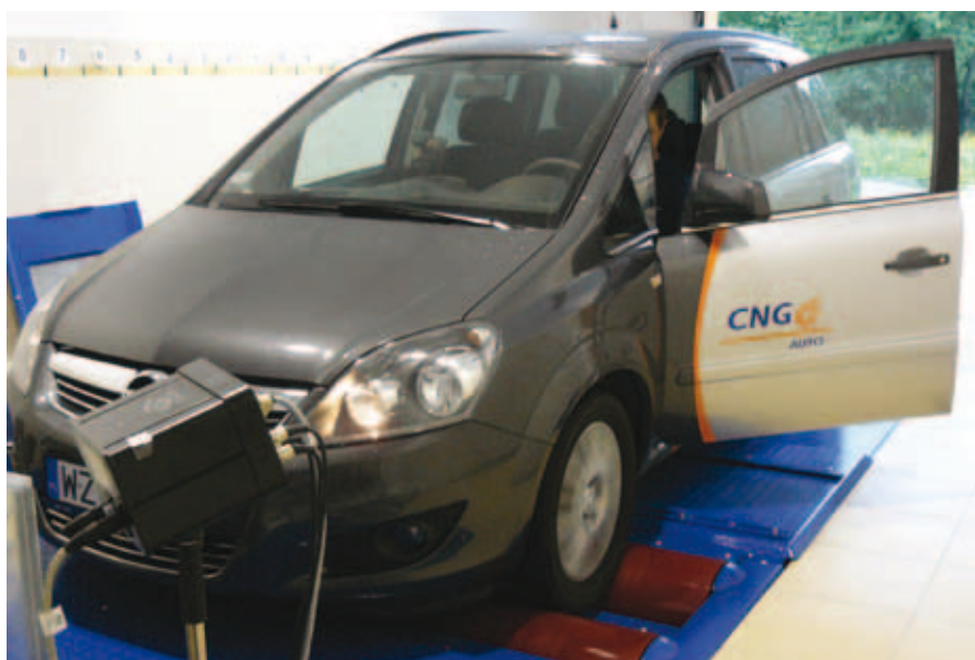
Do badań hamownianych użyto samochodu osobowego przystosowanego fabrycznie do alternatywnego zasilania benzyną i sprężonym gazem ziemnym CNG.
