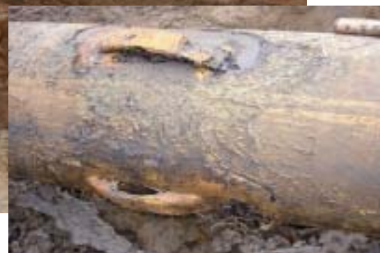
Rys. 4. Dospawane metalowe dystanse, powodujące zwarcie galwaniczne.
