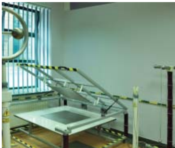
Stanowisko po lewej – do badań wskaźników napięcia, a po prawej do badań dywaników i chodników dielektrycznych.
