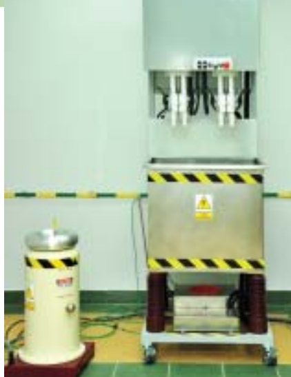
Stanowisko do badań sprzętu ochronnego gumowego (rękawic, trzewików, kaloszy dielektrycznych).
