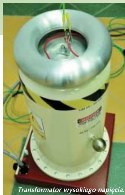
Stanowisko do badań sprzętu ochronnego gumowego (rękawic, trzewików, kaloszy dielektrycznych).
