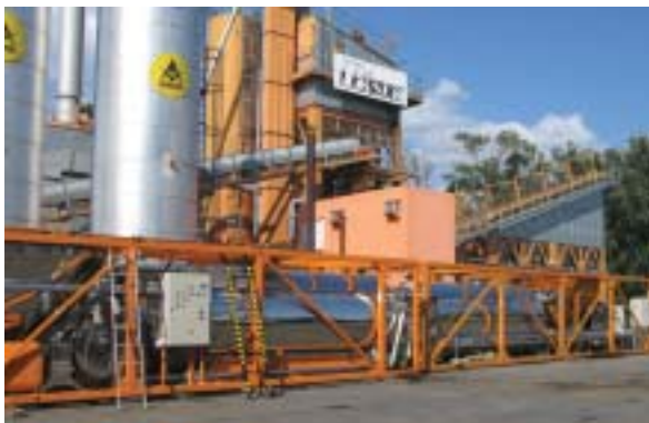
Łączarnia w Krępicach, linia produkcyjna asfaltu gumowego; na pierwszym planie opatentowana maszyna do wytwarzania mieszanek mineralno-bitumicznych modyfikowanych gumą.
