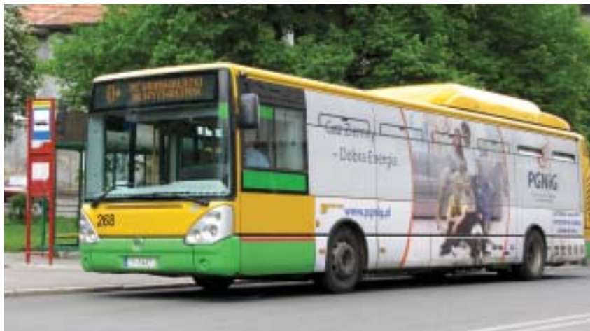
Zdjęcie jednego z nowych autobusów MPK w Wałbrzychu – IRISBUS PS09 AGORA CITELIS CNG – z fabrycznie zabudowaną instalacją CNG.
