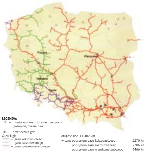
Rys. 6. Gazociągi przesyłowe wysokiego ciśnienia (stan w 1990 r.)
