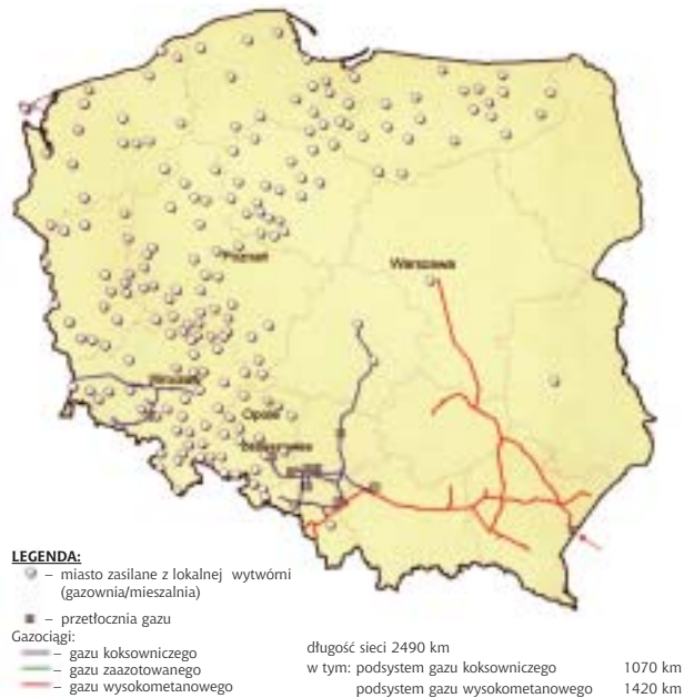
Rys. 3. Gazociągi przesyłowe wysokiego ciśnienia (stan w 1960 r.)
