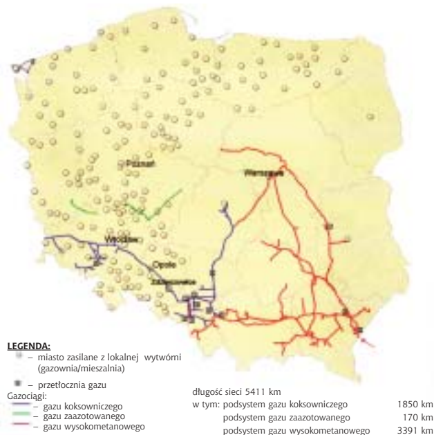
Rys. 4. Gazociągi przesyłowe wysokiego ciśnienia (stan w 1970 r.)
