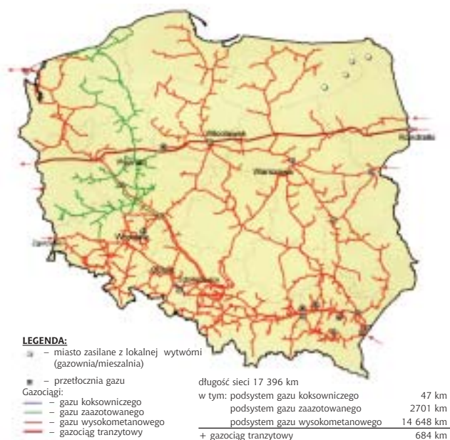
Rys. 7. Gazociągi przesyłowe wysokiego ciśnienia (stan w 2000 r.)
