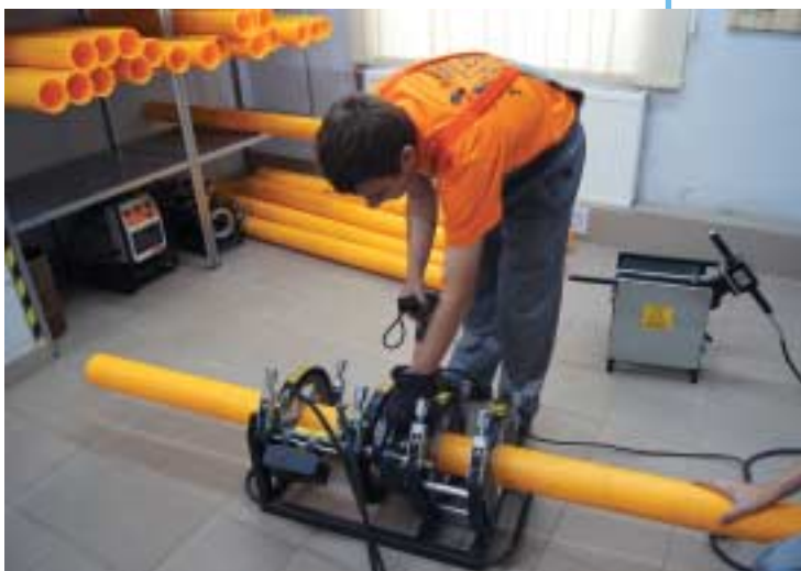
Zgrzewanie polietylenu w warsztatach szkolnych.
