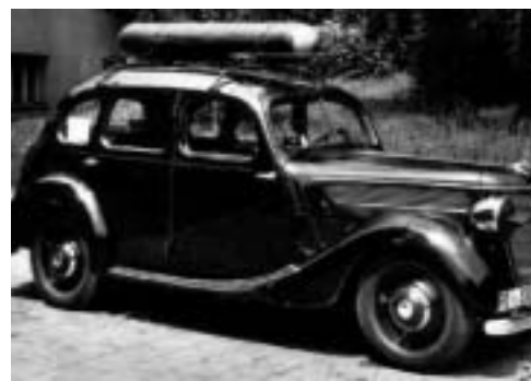
Pierwsze pojazdy, w których dokonano konwersji zasilania na CNG metodą nakładkową.
