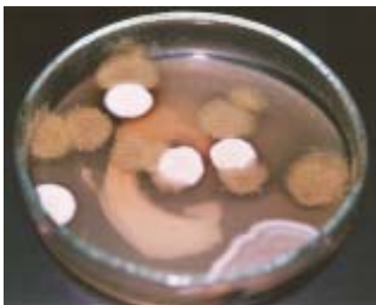
Fot. 2. Przykład rozwoju grzybów pleśniowych, wykorzystujących w procesach metabolicznych organiczne składniki płuczki wiertniczej.
